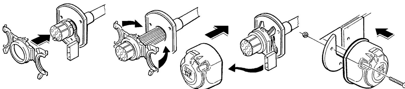
Die auf dem Leitungssatz montierte Gummitülle positionieren und in das Durchführungsloch zum Kofferraum einsetzen.
