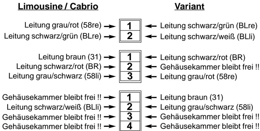
8. Diese drei Steckgehäuse in die dafür vorgesehenen Steckbuchsen am linken Rücklicht, in den Lampenträger stecken und verrasten lassen.
